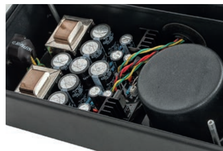
Główny transformator jest podwójnie izolowany – okrągłą osłoną oraz subchassis w całej sekcji.
