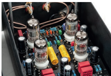
W LP-1 na lampach przygotowano dwa stopnie wzmocnienia.
